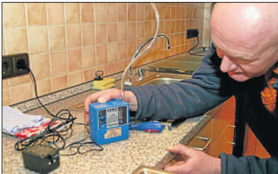
Misst die Raumluft: Umweltberater Hans-Joachim Marciniak (Bad Emstal) prüft mit einer speziellen Pumpe die Luft im Vereinsraum des TV Simmershausen im Haus der Vereine auf Formaldehyd.
